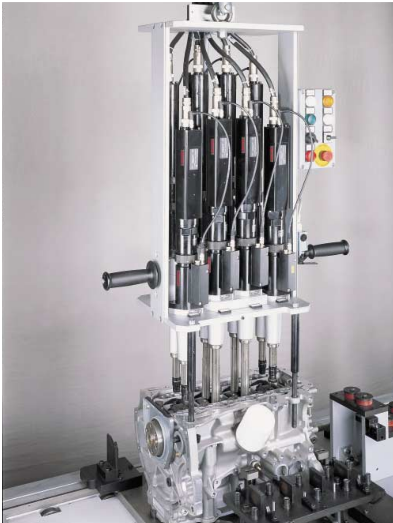
Hand-held 8-fold nutrunner for the assembly of connecting rods Atornillador manual de 8 elementos para el montaje de bielas Parafusadeira manual de 8 elementos para a montagem de bielas
